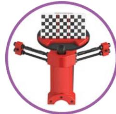
Конструктор для сборки 3D сканера **BQ Ciclop** с комплектом ПО, драйверов и руководством по сборке – 2 шт.
